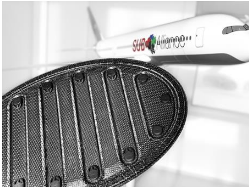
Figure 4 : Composant aéronautique avec des inserts surmoulés
